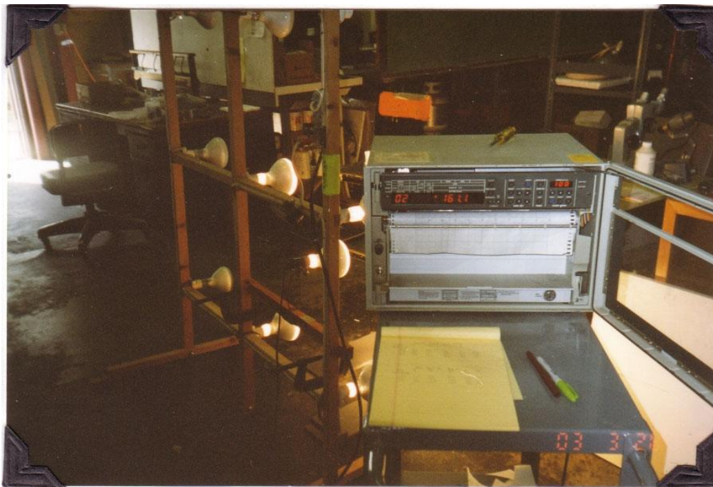
Фотография милливольтного самопишущего прибора регистратора и совокупности солнечных ламп
